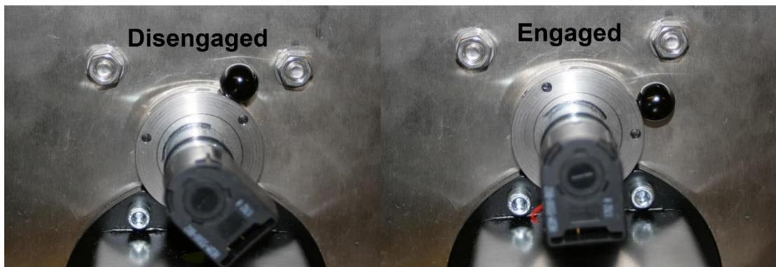
**DO NOT USE THE MOTOR/ENCODER ITSELF TO ENGAGE/DISENGAGE THE MOTORS**
